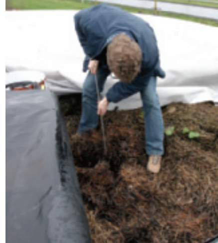
Dahn gräver och gräver i det skyddande och isolerande halmlagret för att komma ner till den slang som släpper ut det förorenade vattnet högst upp i reningsverket. När vattnet silats igenom materialet och bakterierna gjort sitt pumpas det reade vattnet ut i det kommunala avloppssystemet.
